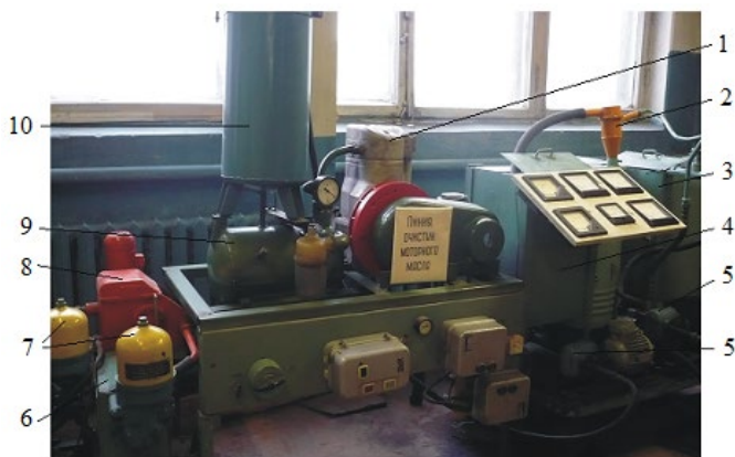
Рисунок 2 - Линия очистки моторного масла
