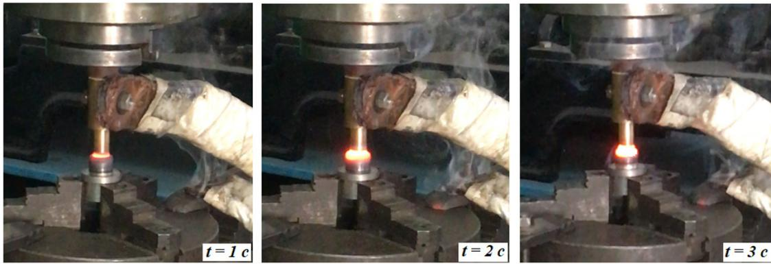
Рис. 3 – Процесс теплонасыщения деформируемого объема образца
