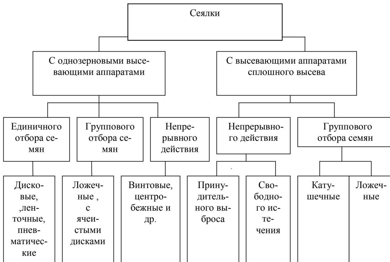
Рисунок 1 – Классификация сеялок по типу высевальных аппаратов
