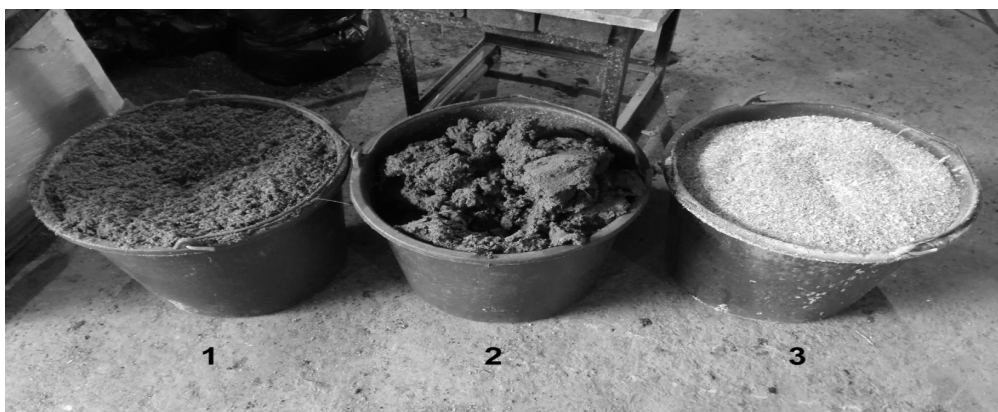
Рис. 1 – Компоненты ферментируемой смеси: 1 – твердая фракция свиного навоза после шнекового сепаратора; 2 – твердая фракция свиного навоза после декантерной центрифуги; 3 – отходы механической очистки зерна
