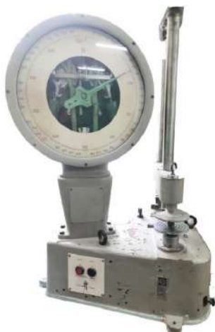
Рис. 2 – Исследование пружины сжатия
