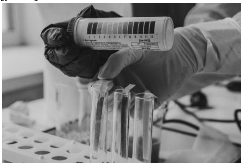
Рис. 4. Сравниваем изменения цвета полосок со шкалой.
