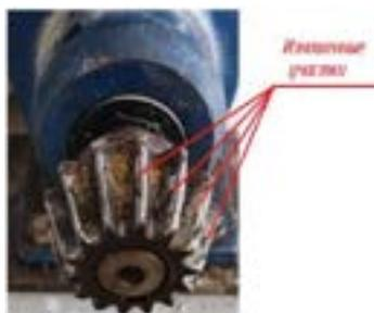
**Рисунок 4 – Изношенные участки шестерни мотор-редуктора ротационной хлебопекарной печи FIMAK FD-150**
