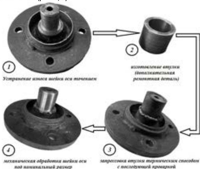
**Рисунок 2 - Последовательность операций восстановления шейки оси катка дисковой бороны БДП-7 постановкой дополнительной ремонтной детали**
