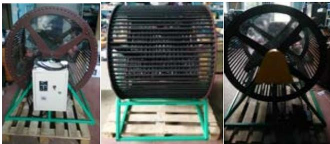
**Рисунок 2 – Общий вид макетного образца устройства для оценки пригодности сортов и гибридов к механизированной уборке:**
