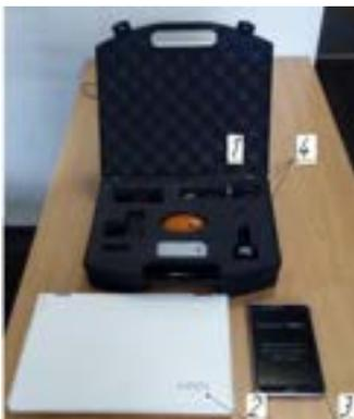
**Рисунок 3 – Общий вид программного инструмента «Электронный картофель Tuber Log»:** 1 – регистратор данных; 2 – персональный компьютер; 3 – планшетный компьютер; 4 – вспомогательная аппаратура
