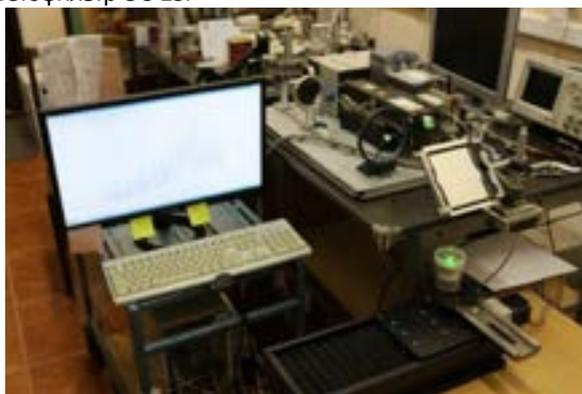
**Рисунок 6 – Общий вид экспериментальной установки для регистрации спектров флуоресценции на основе лидара комбинационного рассеяния**
