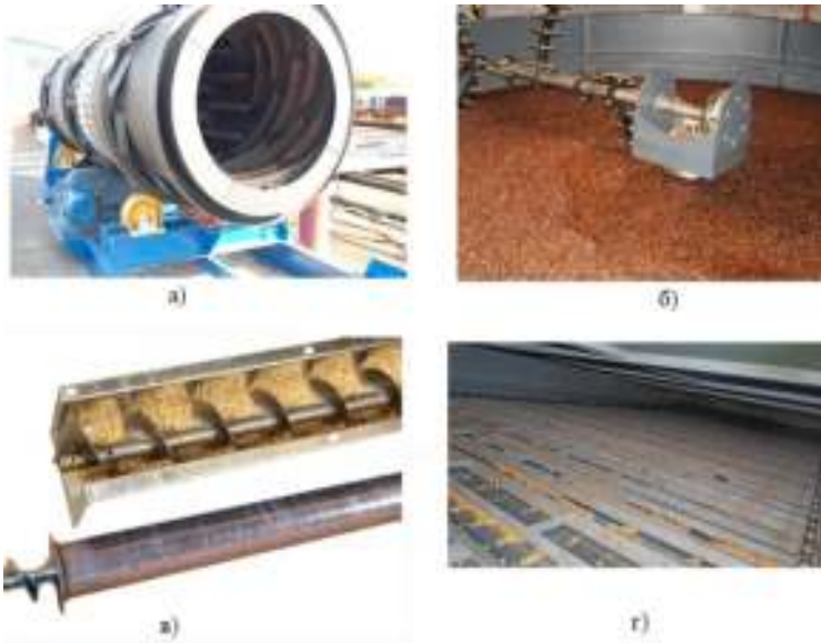
а) - барабан с перегородками; б) –зубчатый ворошитель зерна; в) –шнековый рабочий орган; г) –скребковый рабочий орган
