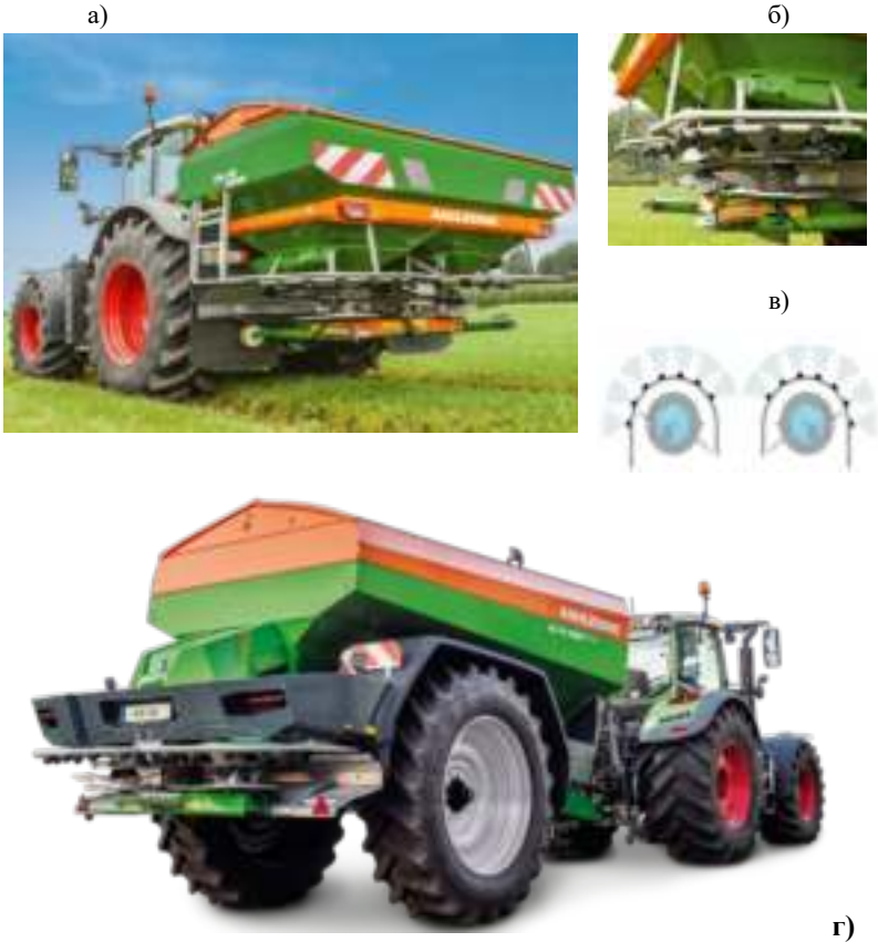
Рис. 1 – Разбрасыватели минеральных удобрений с цифровым управлением техпроцесса специальными радарными-датчиками: а)-навесной - ZA-TS, б, в) датчики контроля распределения удобрений, г)-прицепной – ZG-TS
