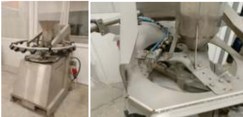
Рис. 4 – Стенд для оценки динамических свойств удобрений по траектории полета для проверки установленных оптимальных
