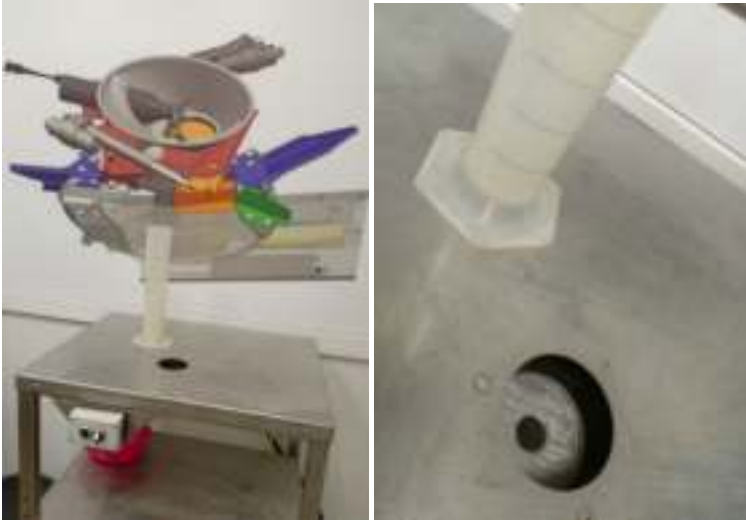
Рис. 2 – Оборудование для определения скорости прохождения удобрений из бункера на рабочий орган-метатель удобрений
