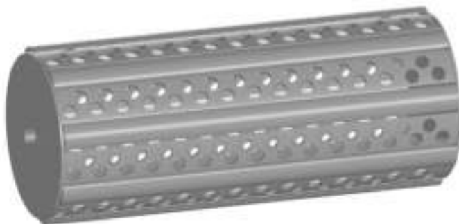
Рис. 6 – 3D модель волнового катка
