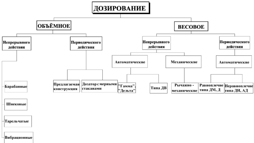
Схема 1. Классификация методов дозирования сыпучих материалов.
