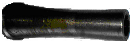
Рис. 1. Профилированное сопла деэмульгатора
