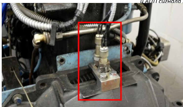
в) датчики отметки зубьев маховика и верхней мертвой точки
