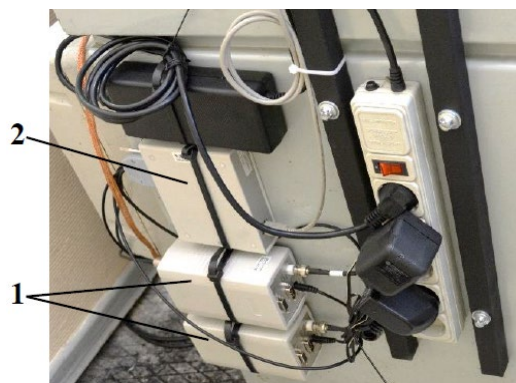
б) усилитель заряда РШ2731Э (1) и АЦП сигнала ЛА-2USB (2)
