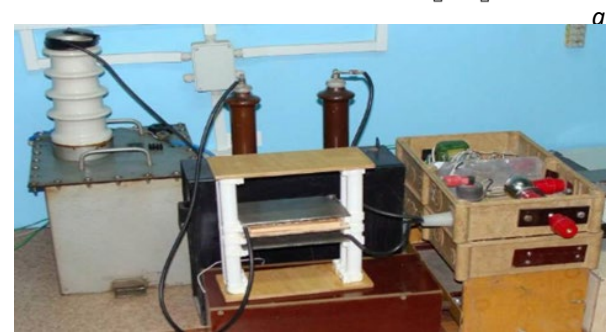
Рис. 2. Схема подключения элементов в экспериментальной установке для обработки в ЭППрВН и ЭППВН (а) и установка, собранная для изучения обработки семян в ЭПИВН (б)
