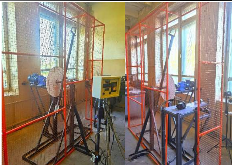
Рисунок 1 – Лабораторная установка (ротационный копёр) для изучения резания растительных материалов
