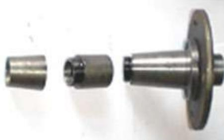
**Рисунок 4 - Сменные насадки диафрагмы гидроциклона**
