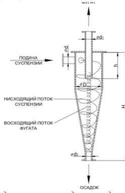
*Гидроциклонов для разделения нестойких эмульсий и суспензий*
