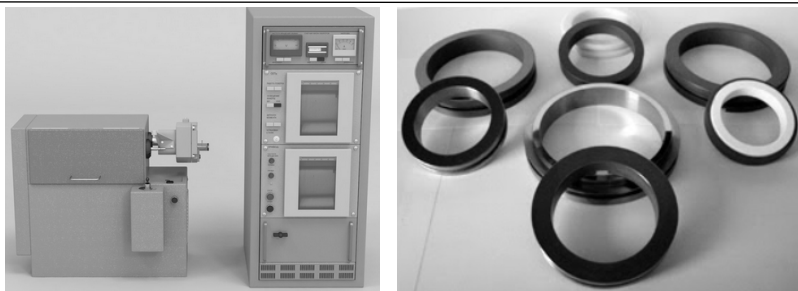
Рисунок 2 - Испытательная машина 2070 CMT-1 и пары трения
