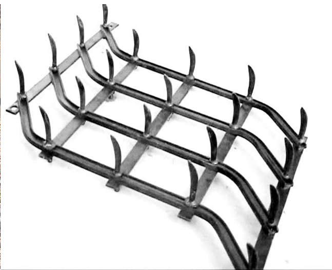
Рис. 4. Борона с эллипсообразной формой и скользяще-режущим принципом работы зуба
