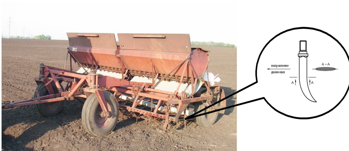
Рис. 5. Комбинированный агрегат для подкормки и боронования озимых
