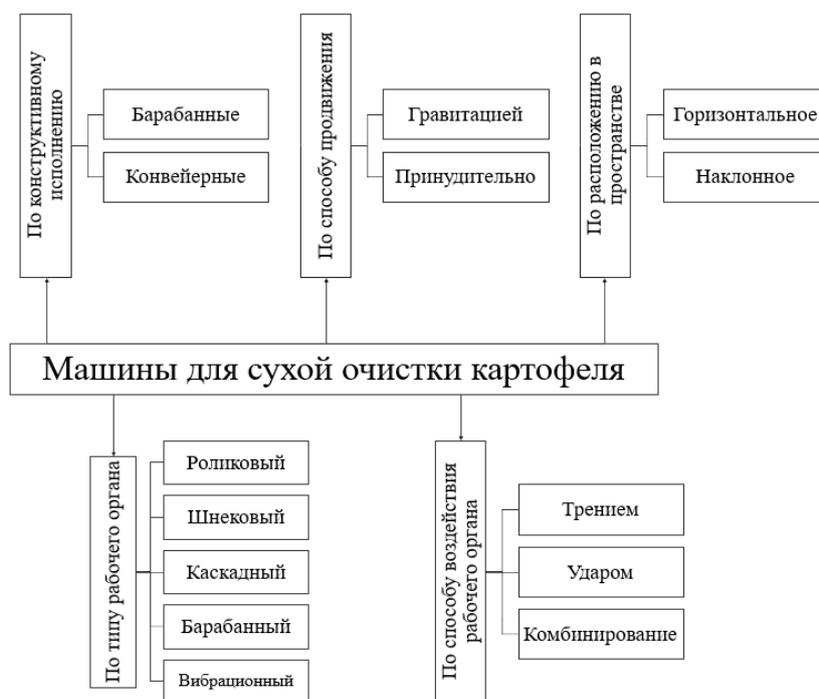
Рис. 1. Классификация машин для сухой очистки картофеля [5, 6, 7]
