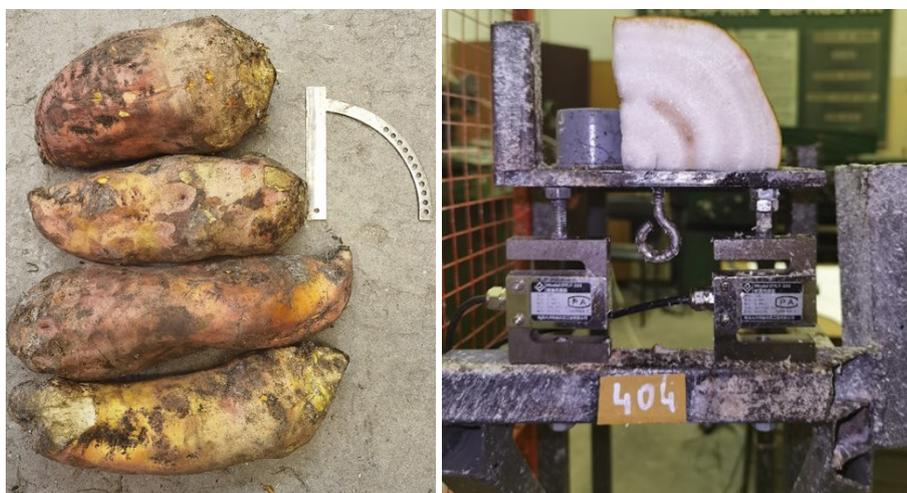
Рис. 1. Подготовка к проведению опытов по определению удельного усилия резания кормовой свеклы сорта Линда
