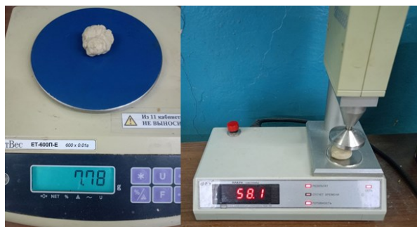
Рис. 4 – Определение количества и качества сырой клейковины в зерне сорта озимой пшеницы мягкой Октябрьская, 2023 г.
