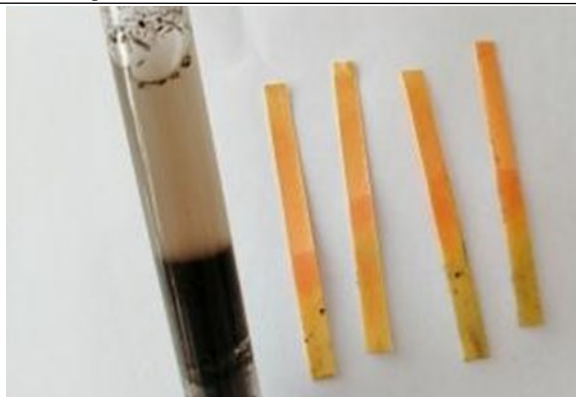
Рис. 1 - Определение pH почвы
