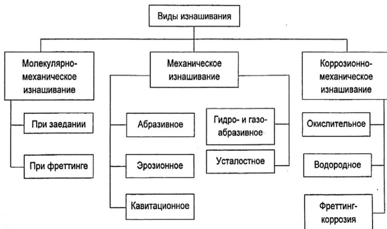
Рис. 1 – Схема видов изнашивания деталей
