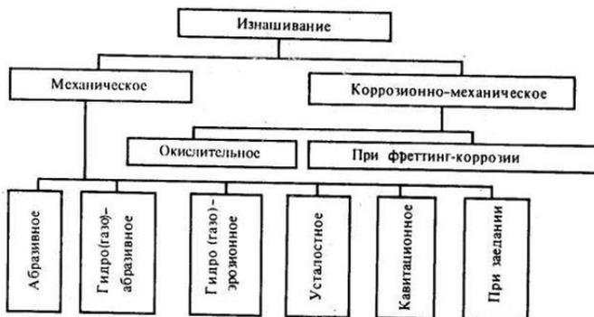
Рис. 1 – Схема видов изнашивания.
