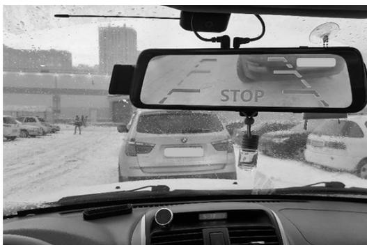
**Рис. 2. Зеркало заднего вида с функцией включения камеры заднего вида**
