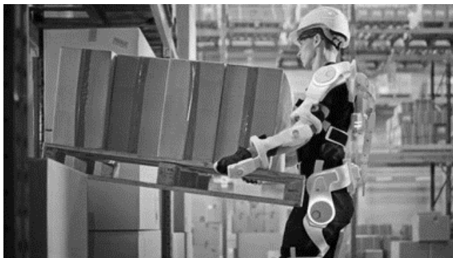
Рис. 1 - Экзоскелет, расширяющий физические способности человека
