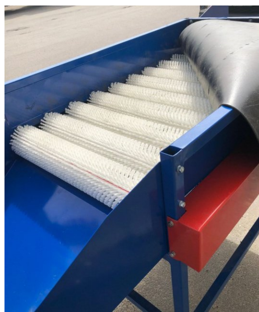
Рис. 1. Рабочие органы щеточного очистителя корнеплодов ЩО-10
