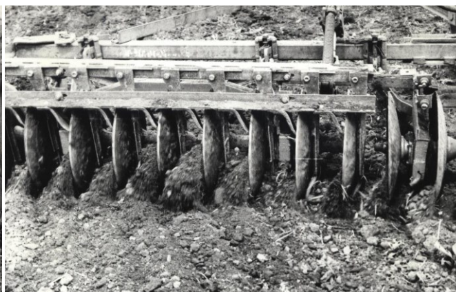
Рис. 8. Работа односторонних плоскорежущих лап с изогнутой нижней частью стоек в комбинации с секцией сферических дисков луцильника
