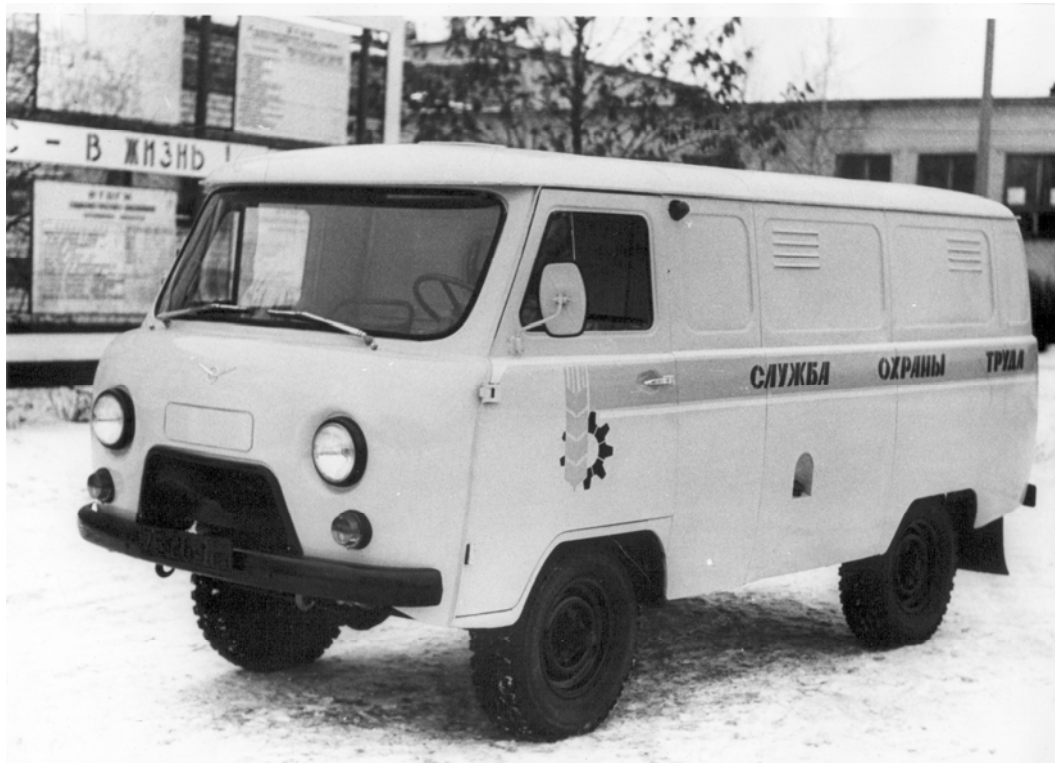
Рис. 1 Передвижной кабинет по охране труда на базе автомобиля УАЗ-452
