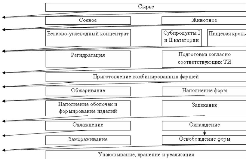
**Рис. 1. – Технологическая схема производства фаршированных кулинарных изделий и мясных хлебов кровяных на основе комбинированных фаршей**
