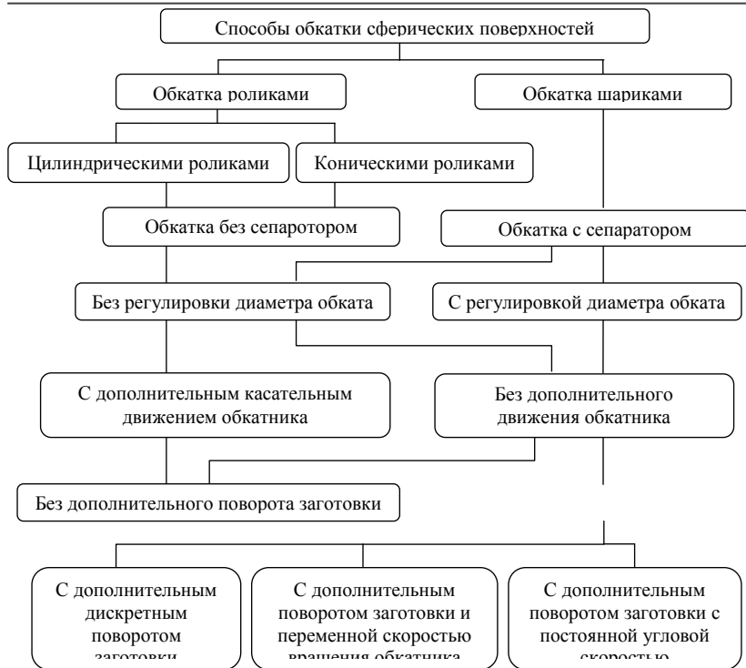
Рис. 1. - Структурная схема способов обкатки неполных сферических поверхностей.
