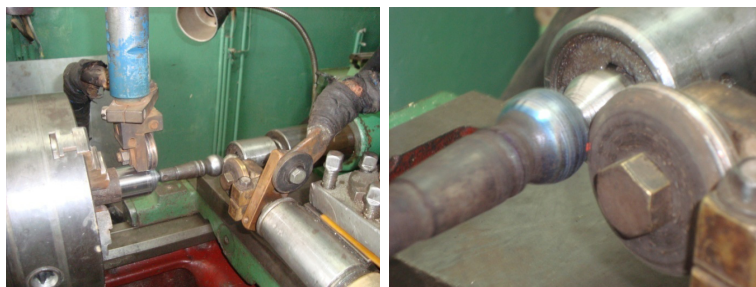
Рис. 3. – Электромеханическое упрочнение шаровой поверхности.
