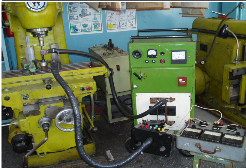
Рис. 2. – Экспериментальная установка для электромеханического дорнования тонкостенных бронзовых втулок.
