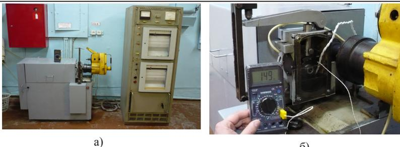
Рис. 3. – Машина трения 2070 СМТ-1: а) общий вид; б) испытательная камера
