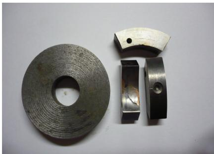
Сравнительные лабораторные испытания были проведены на машине трения 2070 СМТ-1 (рис.3 а) по стандартной методике [3-4].
