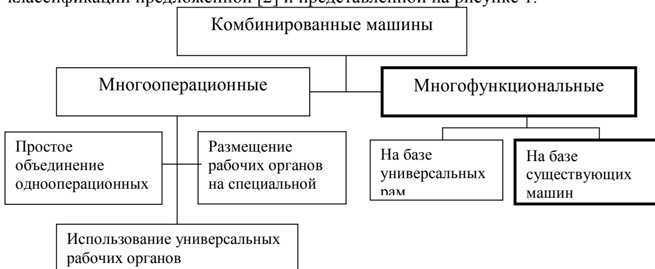
Рисунок 1 – Классификация комбинированных машин и обоснование предлагаемой конструкции
