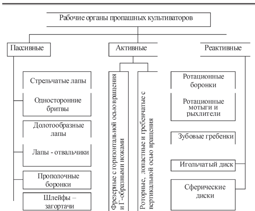
Рис. 1. Классификация рабочих органов по способу преобразования подводимой энергии
