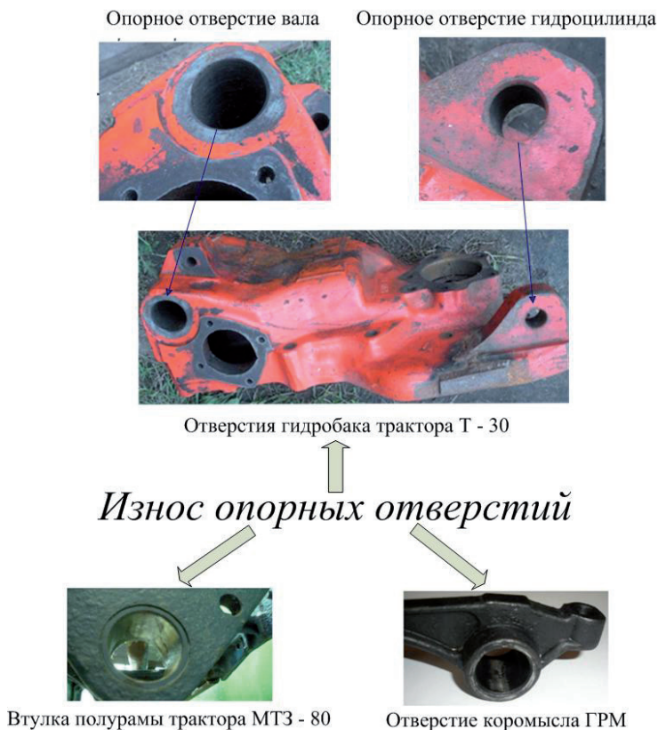
Рис. 2. Износ отверстий деталей сельскохозяйственной техники
