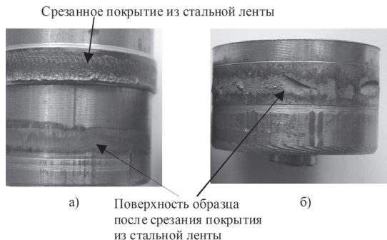
Рис. 5. Поверхность образцов после испытания на прочность сцепления покрытий из стальной ленты при режимах: а) I=2 кА, t_{\text{имп}}=0,06 с., t_{\text{паузы}}=0,08 с., б) I=3,9 кА, t_{\text{имп}}=0,12 с., t_{\text{паузы}}=0,2 с.
