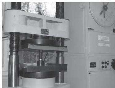
Рис. 2. Схема испытания и пресс для испытания прочности сцепления покрытия на срез: 1- образец; 2- покрытие; 3- кольцо.
