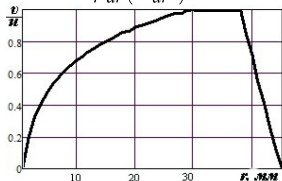
Рис.1. Распределение скоростей движения зерна в бункере спирально-винтовым транспортером
