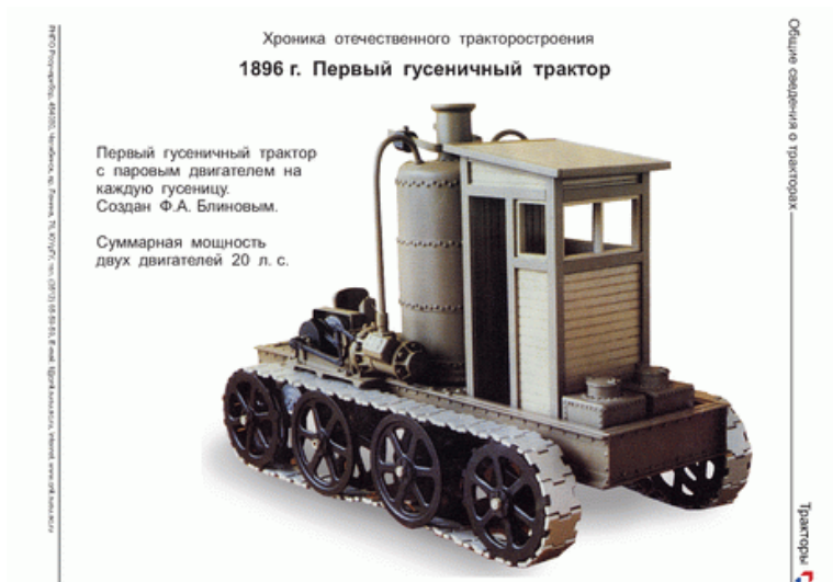
Рисунок 2 – Гусеничный трактор Блинова с двумя паровыми двигателями.
