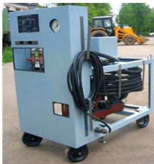
**Рисунок 3 - Агрегат топливо- и маслоочистительный ПГ 223**
