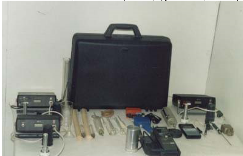
Рисунок 2 Комплект средств экспресс – контроля качества ТСМ для тракторов и самоходных машин КИ-28105
