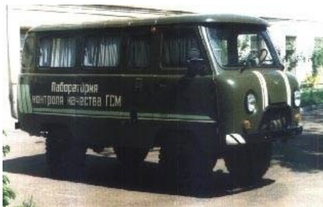
Рисунок 1 Передвижная лаборатория КИ-28099 контроля качества ТСМ.
