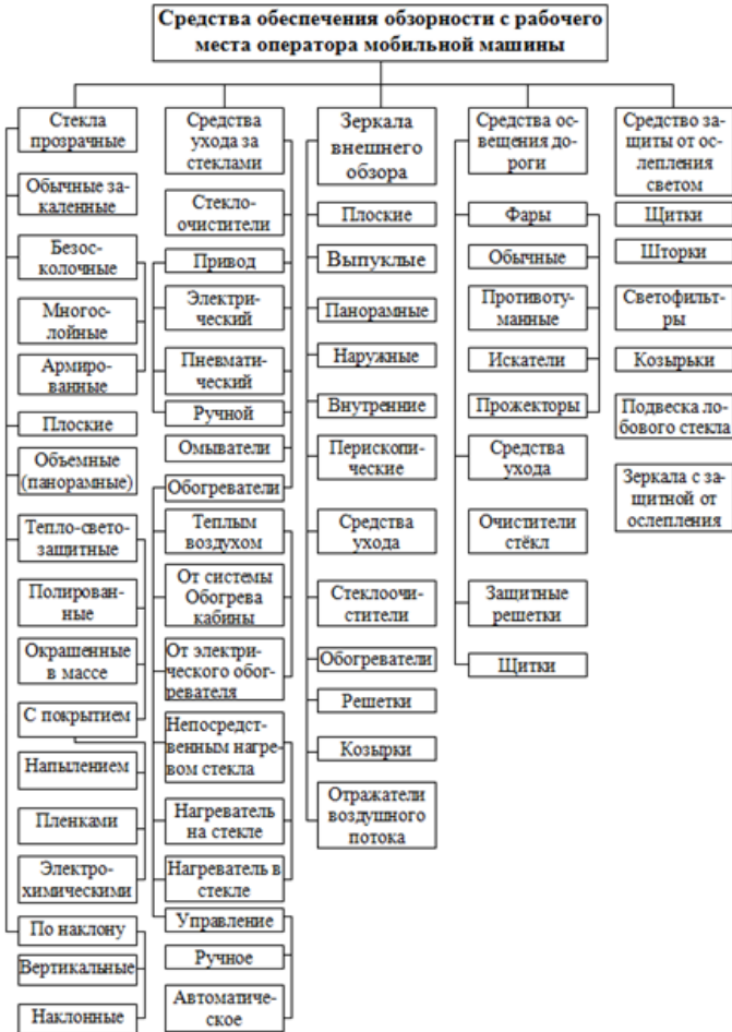
Рисунок 1 – Классификация средств обзорности с рабочего места оператора мобильной машины
