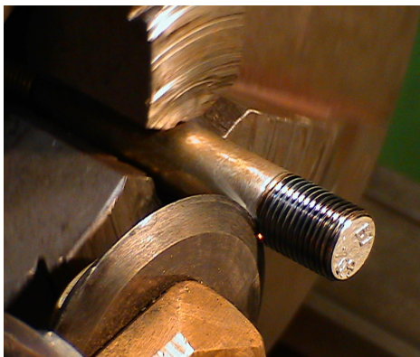
Рис. 2. Зона контакта «инструмент-резьба»
