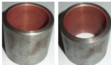
Рисунок 2 – Втулки с нанесенным на поверхность отверстия ФАБО покрытием
