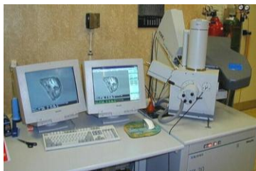
Рисунок 4 – Внешний вид сканирующего электронного микроскопа Philips XL30 ESEM-TMP
