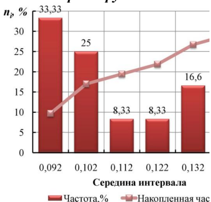
Рисунок 7 - Износ отверстий поворотного кулака автомобиля КАМАЗ по размеру Б
