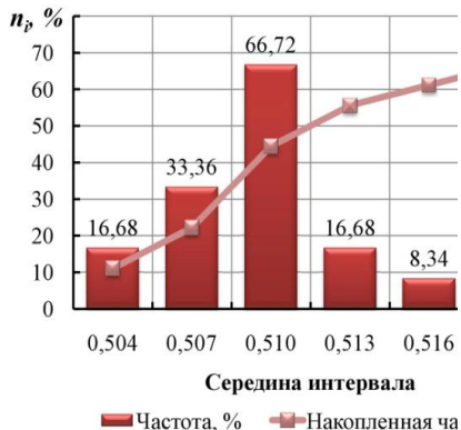
Рисунок 5 - Износ отверстий поворотного кулака автомобиля КАМАЗ по размеру А
