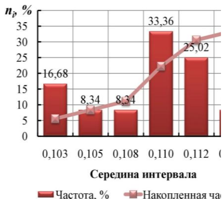
Рисунок 4 - Износ отверстий вилки карданной передачи автомобиля КАМАЗ по размеру А
