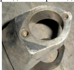
Рисунок 2 – Детали с отверстиями, имеющими эллипсный износ
