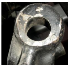
Рисунок 2 – Детали с отверстиями, имеющими эллипсный износ
