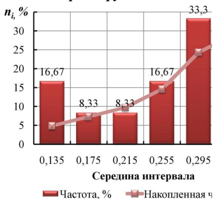
Рисунок 6 - Износ отверстий вилки карданной передачи автомобиля КАМАЗ по размеру Б
