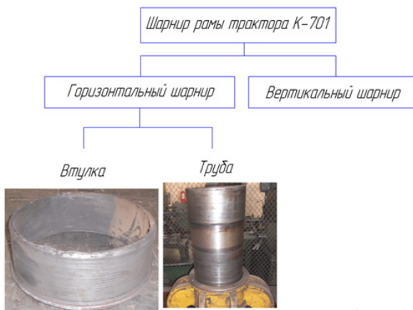
Рис. 3. – Состав шарнира рамы трактора К-701
