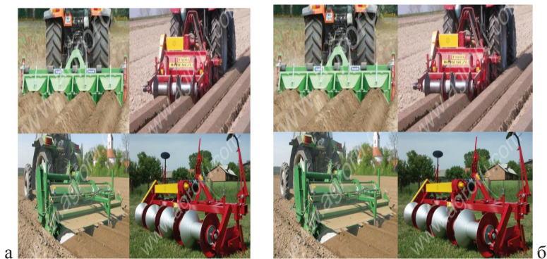
а – устройствами с гребнеобразующими плитами; б – устройствами с профильными катками
