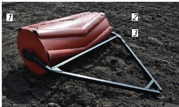
Рисунок 2 – Почвообрабатывающий каток для формирования волнового рельефа почвы
